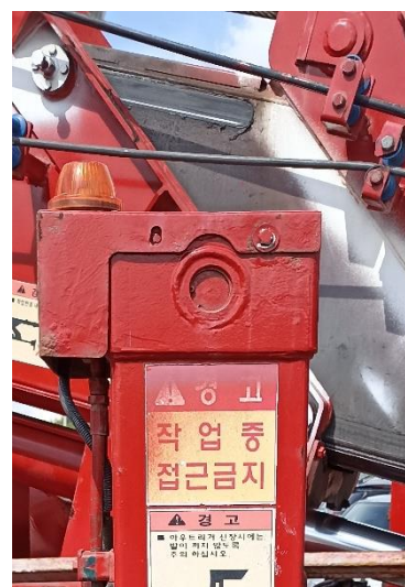
Рис. 10 Сигнальные светильники на выносных опорах (слева – отсутствует)
