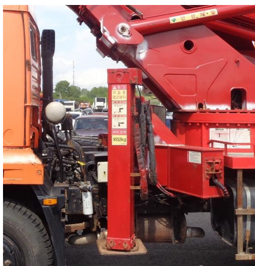
Рис. 10 Сигнальные светильники на выносных опорах (слева – отсутствует)
